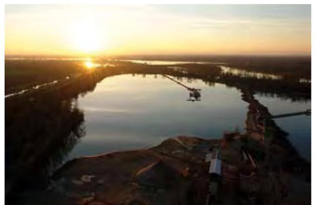
« Coucher de soleil sur les gravières » (© Thierry Dichtenmuller) : Lorsqu'on exploite les granulats dans le lit majeur des rivières, les dépressions ainsi formées se remplissent d'eau provenant de l'aquifère des alluvions au fur et à mesure du creusement.
